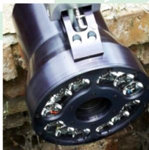
telecamera con sensore video full HD di nuova generazione ad alta sensibilità (0,01 lux) per immagini nitide e luminose
